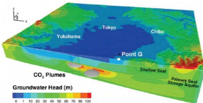
図-4 CO<sub>2</sub>圧入後の地下水圧（全水頭換算）の分布（100 年後）
