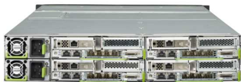
Fujitsu PRIMERGY CX400 M1 シャーシ当たりCX2550 M5 × 4搭載
