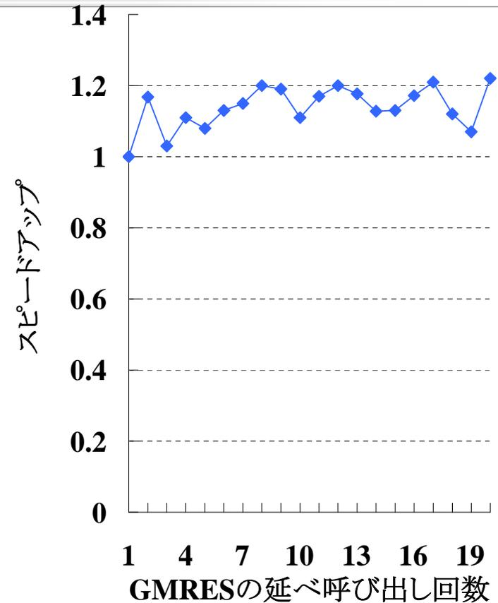
しかし、・基底ベクトルを用いる演算のコストが大きいいため、スピードアップは最大でも2割程度
