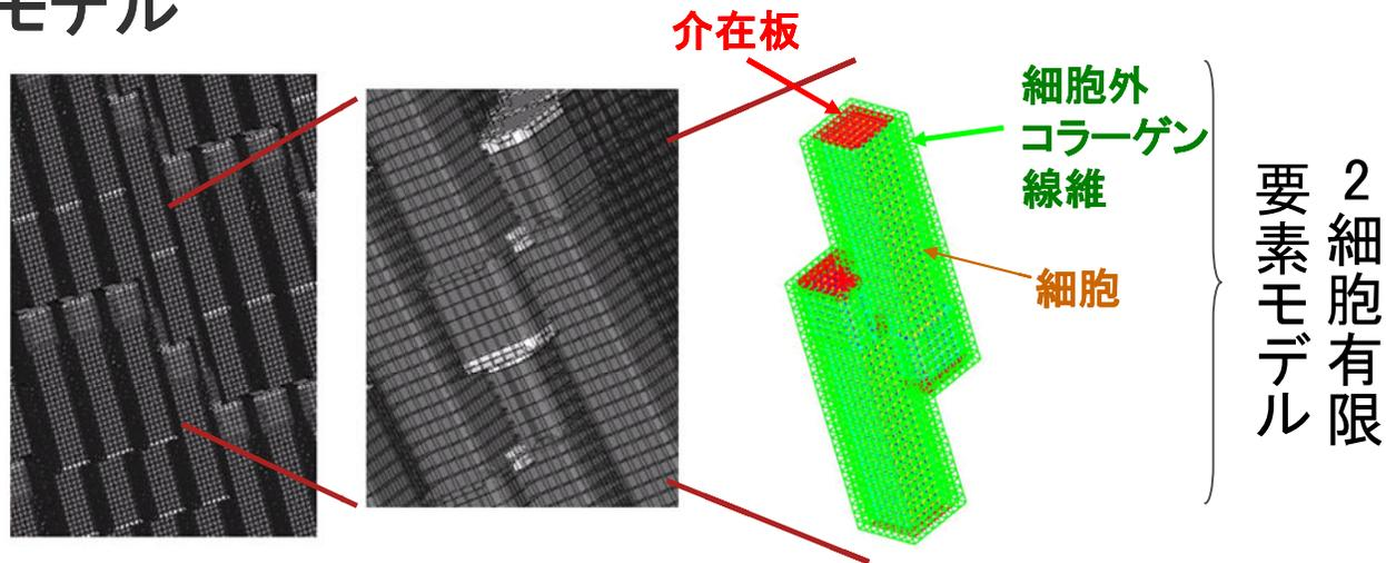
➡ 均質化法(homogenization method)の適用が可能
