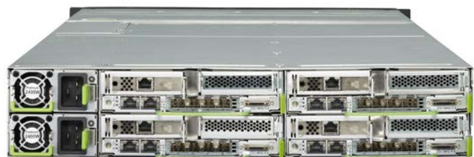
Fujitsu PRIMERGY CX400 M シャーシ当たりCX2550 M5 × 4搭載
