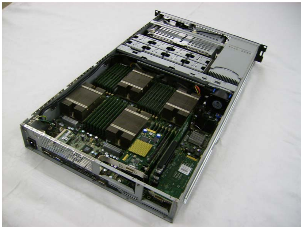
図3 テクニカルサーバ「HA8000-tc/RS425」内部
