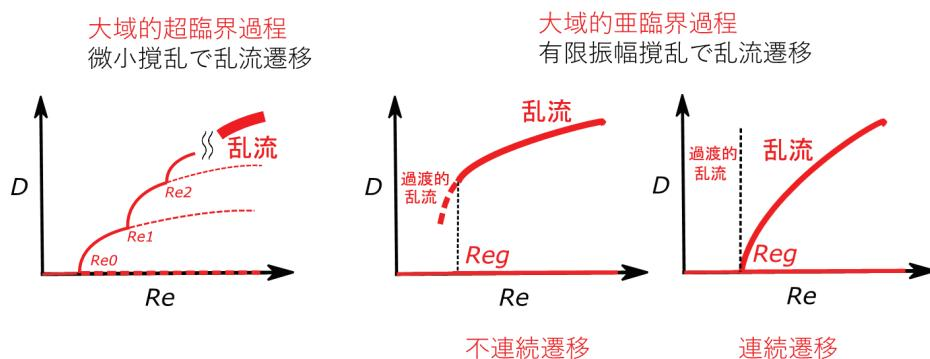
図1 亂流への超臨界遷移と亜臨界遷移。横軸にレイノルズ数、縦軸に層流からの距離を表す。実線は安定状態、点線は不安定状態を表す。
