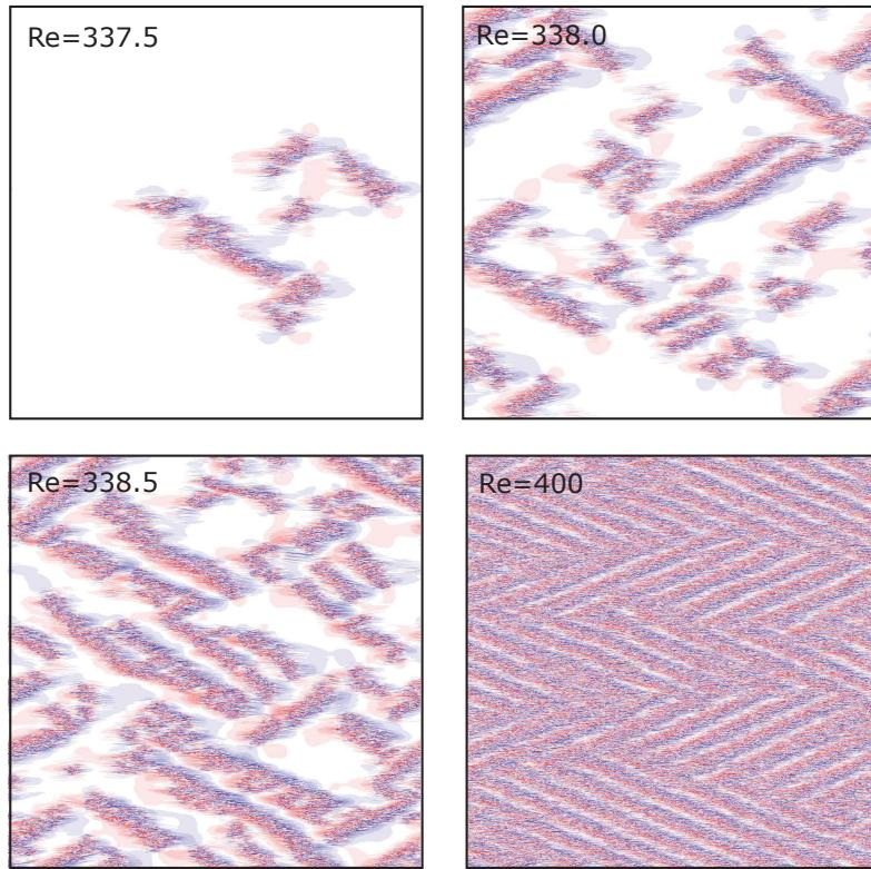
図 5 壁面平行面内の乱流分布. カラーは中央面での壁垂直成分を表す. 流れは右方向である.
