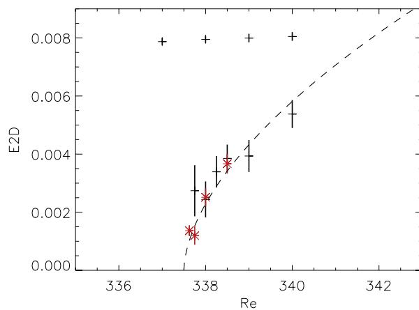
図 6 撥乱エネルギーのレイノルズ数依存性. 赤シンボルは  $1000 \times 1000$ 、黒シンボルは  $500 \times 500$  の壁面平行方向のサイズの結果. 点線は DP 臨界指数を用いた当てはめ曲線である.
