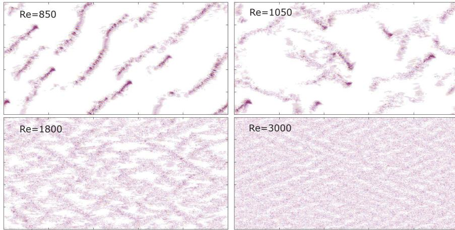
図3 チャネル流での乱流のパターン変化。カラーは中央面での壁垂直成分を表す。流れは右方向である。
