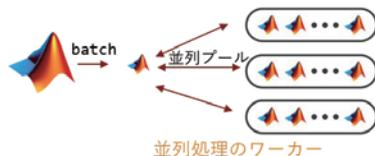
第 4 図: バッチでのオフロード形式の並列処理
