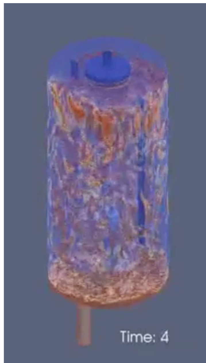
回転攪拌攪拌槽内の流れ mixerVesselAMI
