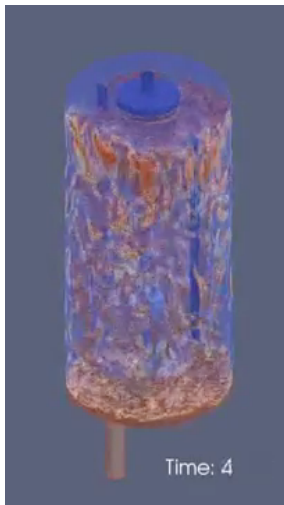
回転攪拌攪拌槽内の流れ mixerVesselAMI
